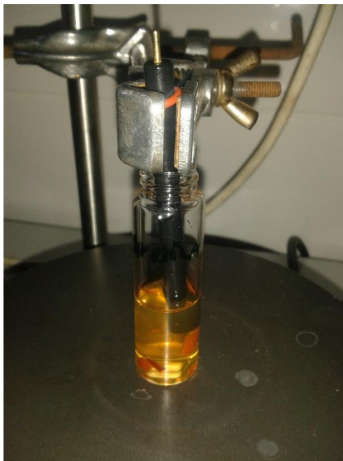
Obr. 3: Akumulácia kapsaicínu na povrch elektródy v extrakte čili papriky
