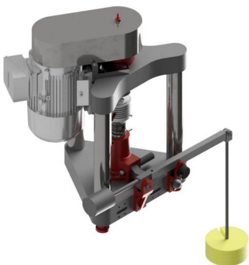
Obr. 2.15: Varianta motor na boku
