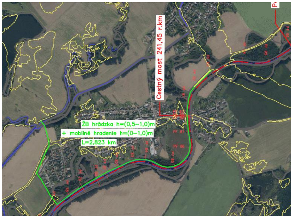
Obr. 8.2: Umiestnenie protipovodňovej ochrany v prvom úseku
