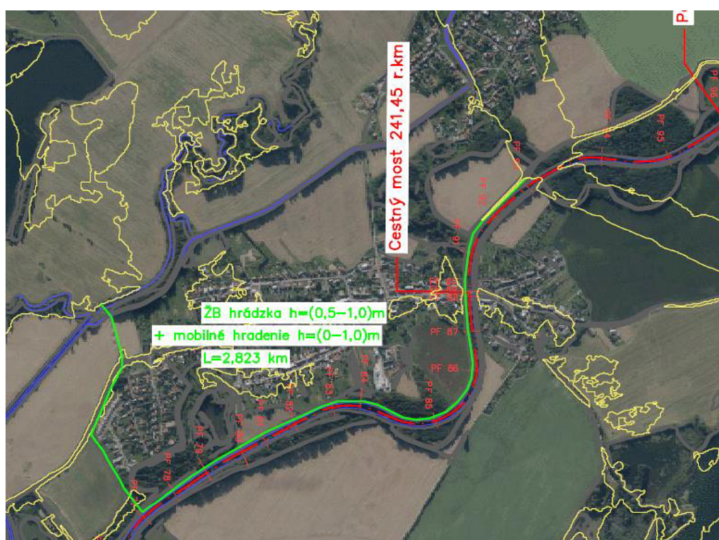
Obr. 8.2: Umiestnenie protipovodňovej ochrany v prvom úseku
