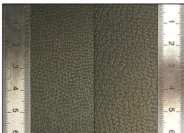
Obr. 21 Struktura dezénu PVC fólie před a po zpracování
