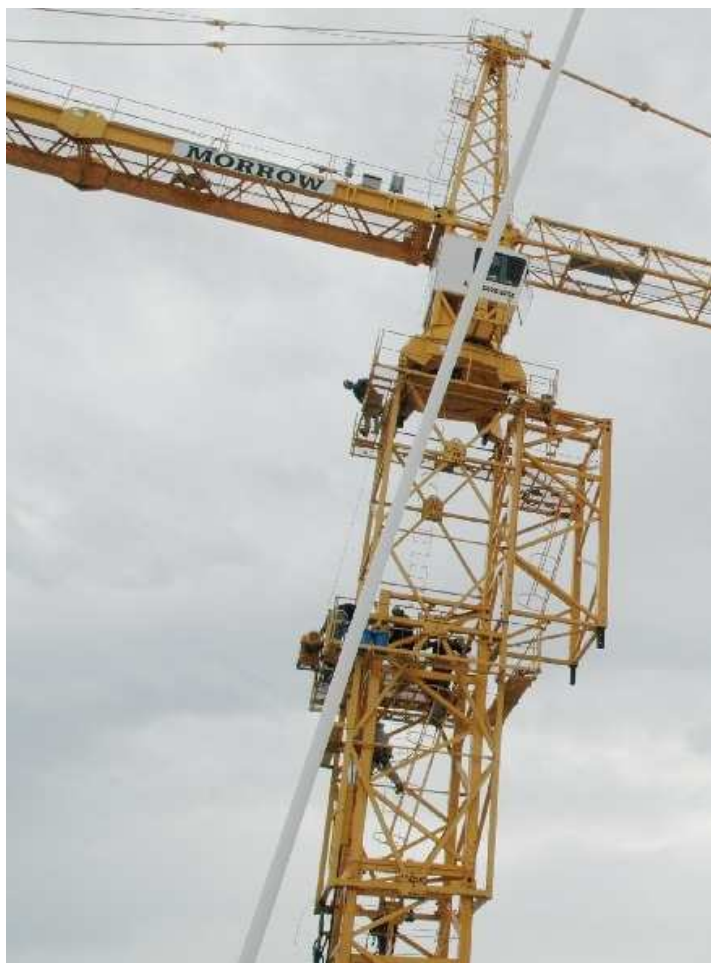
Obr. 6 Ukázka šplhacího zařízení u věžových otočných jeřábů [9]
