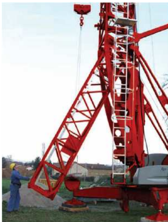
Obr. 5 Ukázka šplhacího zařízení u rychlostavitelných jeřábů Potain [8]
