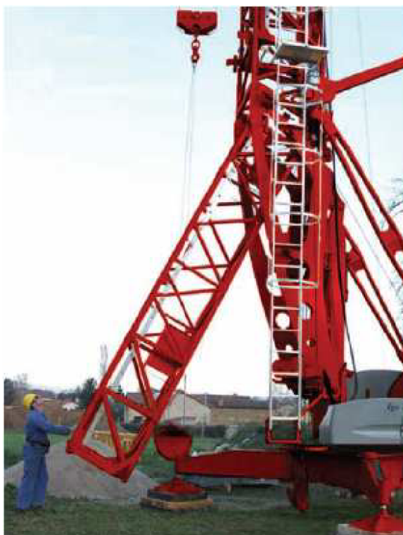
Obr. 5 Ukázka šplhacího zařízení u rychlostavitelných jeřábů Potain [8]
