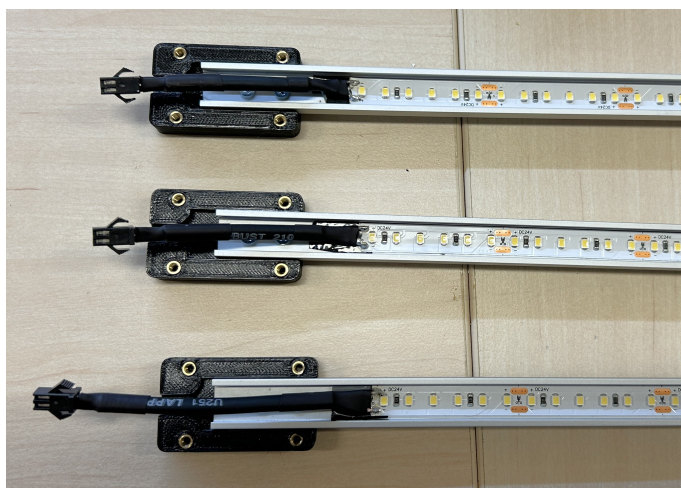
Obrázek 4.15: Zapájené moduly světel s konektory
