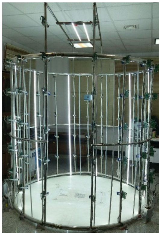
Obrázek 3.7: Postavený systém se 100 kamerami [31].
