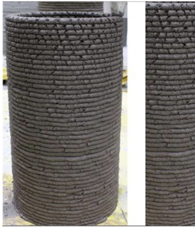
Obrázek 3.3: Změna směsi v průběhu tisku [24].
