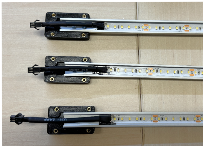
Obrázek 4.15: Zapájené moduly světel s konektory
