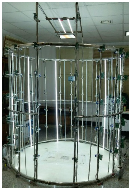
Obrázek 3.7: Postavený systém se 100 kamerami [31].
