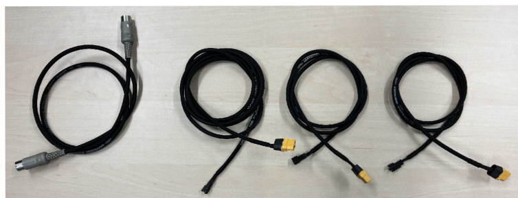
Obrázek 4.16: Kabely pro řízení a napájení světelných modulů
