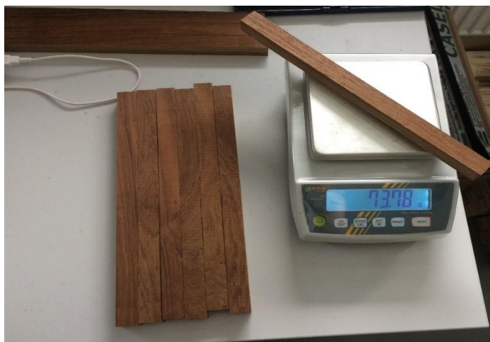
Obr. 16 Vzorky pro zkoušku rázové houževnatosti na digitálních vahách (autor)
