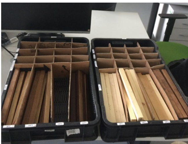
Obr. 15 Zkušební vzorky pro zkoušku rázové houževnatosti (autor)
