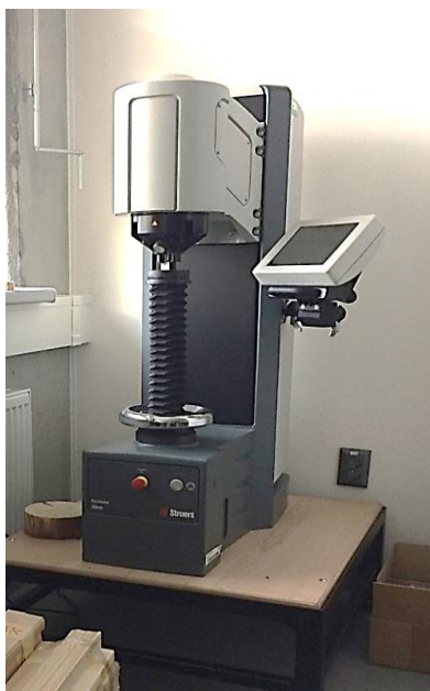
Obr. 20 Tvrdoměr Duravision-30 (autor)
