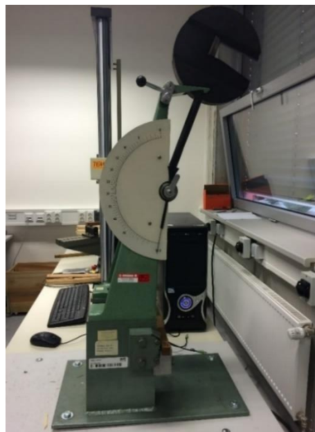
Obr. 23 Umístění zkušební tělesa na podporách kladiva (autor)
