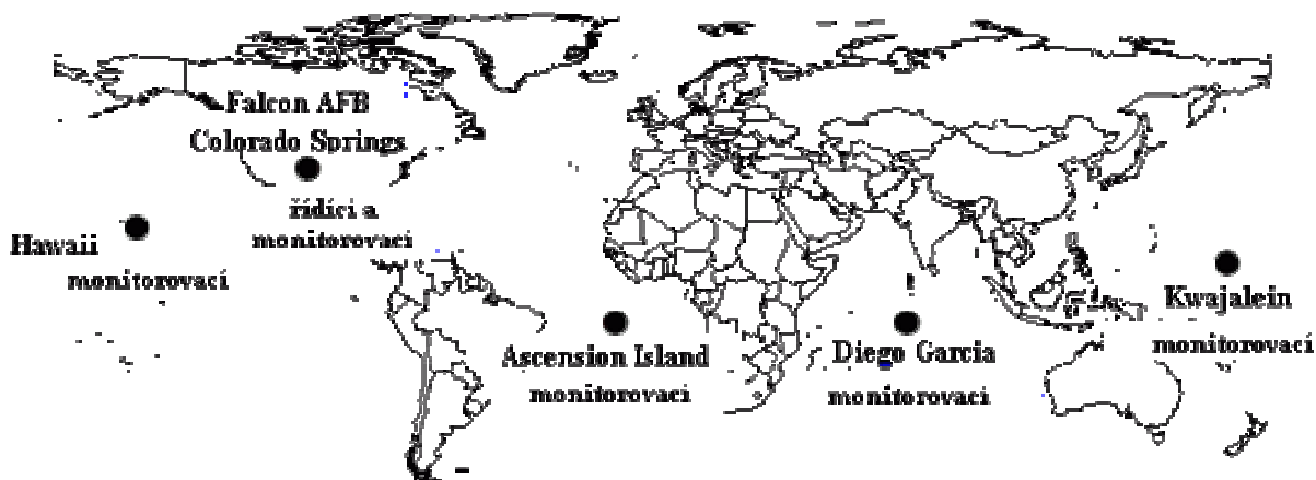
Obr. 2 Rozložení pěti stanic řídicího a kontrolního segmentu systému GPS
