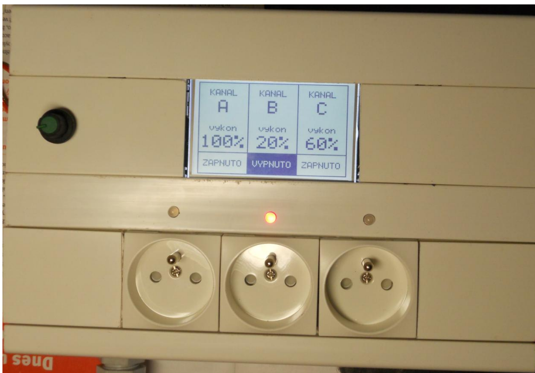
Obr. 3.10: Finální realizace, výchozí zobrazení displeje
