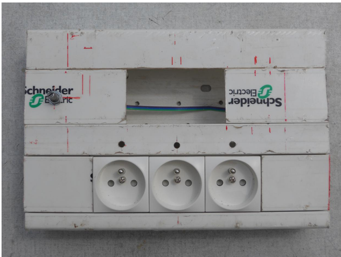
Obr. 3.9: Ukázka úpravy šasi
