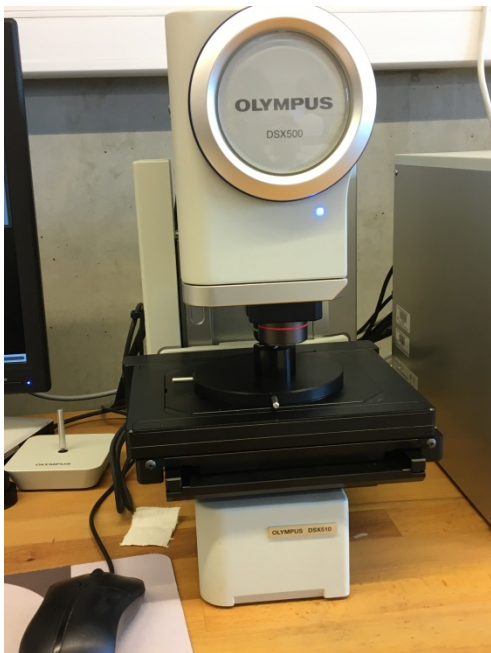
Obr. 16 - Digitální mikroskop Olympus DSX500
