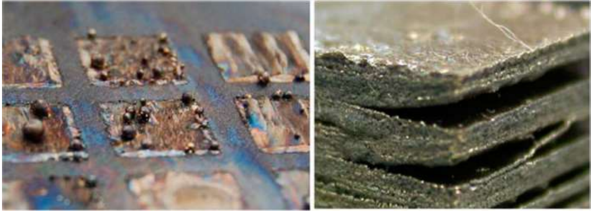
Obr. 3 - Porušení natavením ve tvaru kuliček (vlevo) a delaminace (vpravo) [13]
