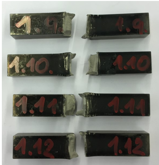
Obr. 30 - Tvářené vzorky zkoušené při teplotě -50 °C
