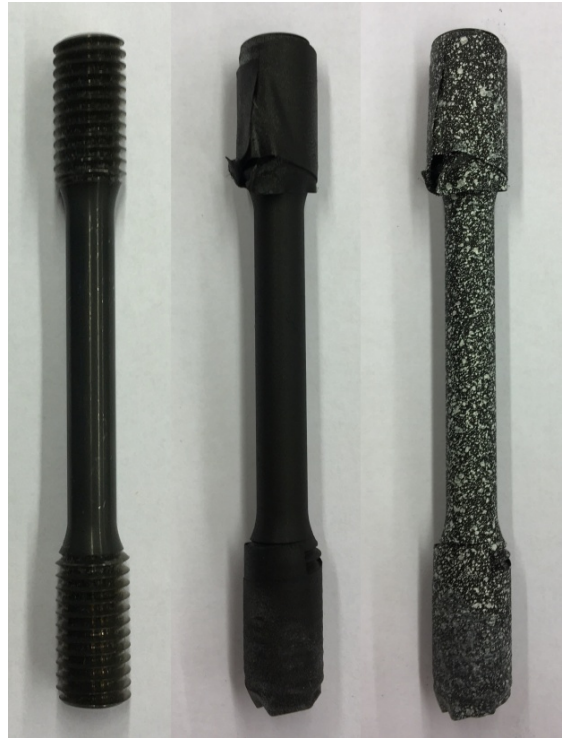
Obr. 25 - Zkušební vzorky tahové zkoušky při vyšších teplotách
