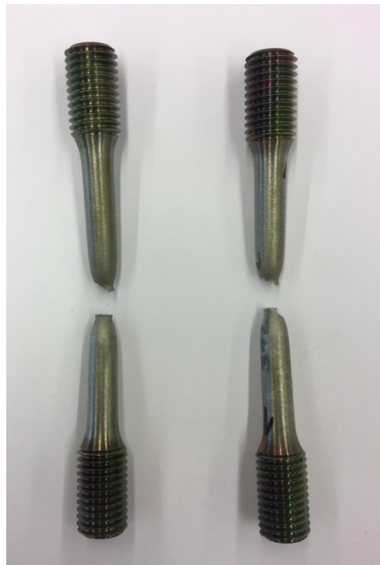
Obr. 22 Přetržené vzorky tahové zkoušky při RT
