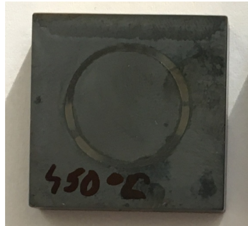
Obr. 36 - Tvářený nitridovaný vzorek zkoušen při teplotě 450 °C
