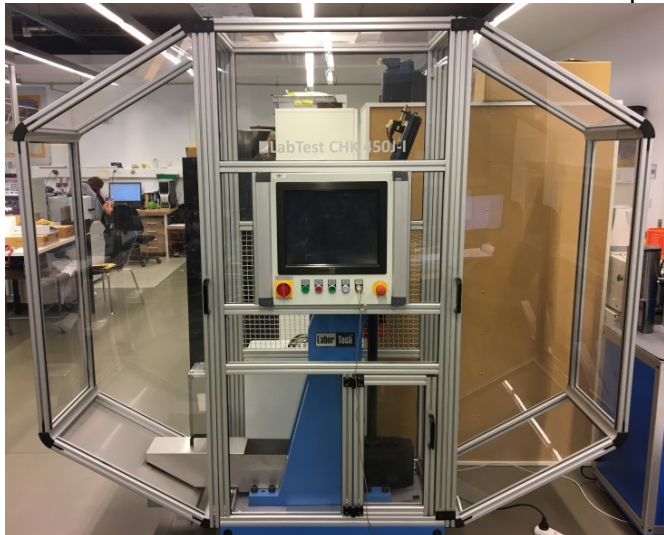
Obr. 29 - Rázové kladivo LabTest CHK 450J-I
