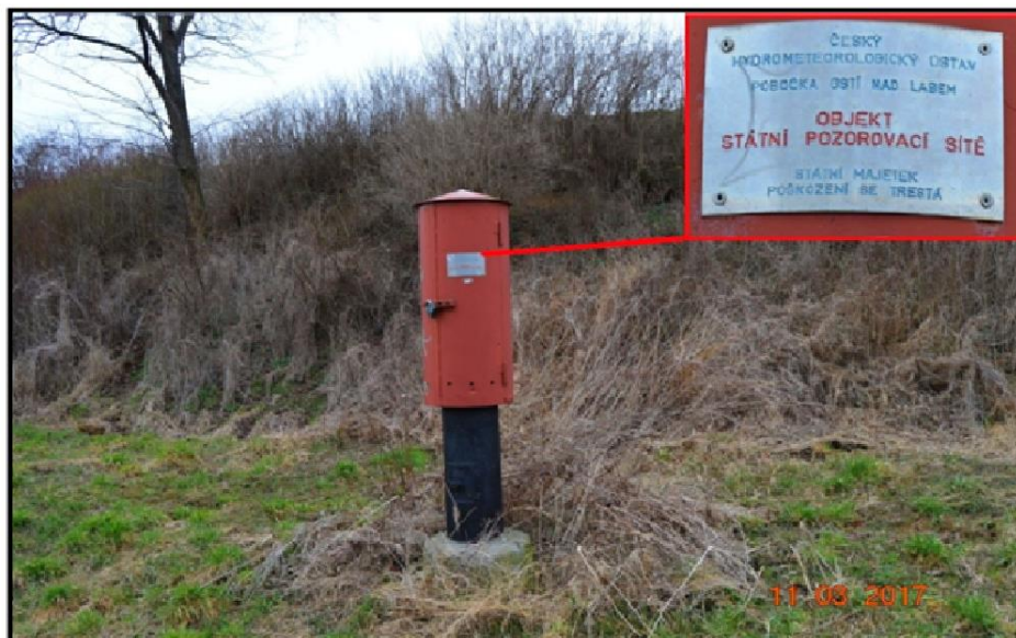
Obr. 3 - Vrt ČHMÚ v Šafranicích pro sledování hladiny podzemní vody
