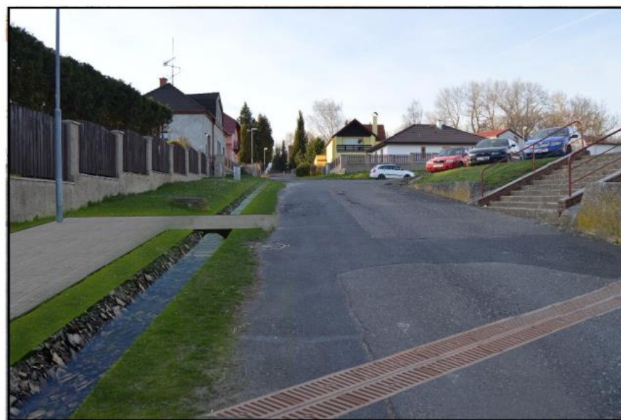
Obr. 9.8 - Vizualizace příkopu v Mládežnické ulici se sběrným roštem
