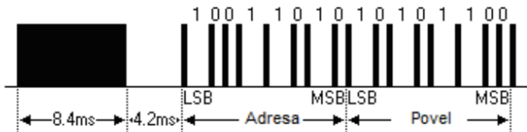
Obrázek 5: Protokol JVC – časový průběh [33]
