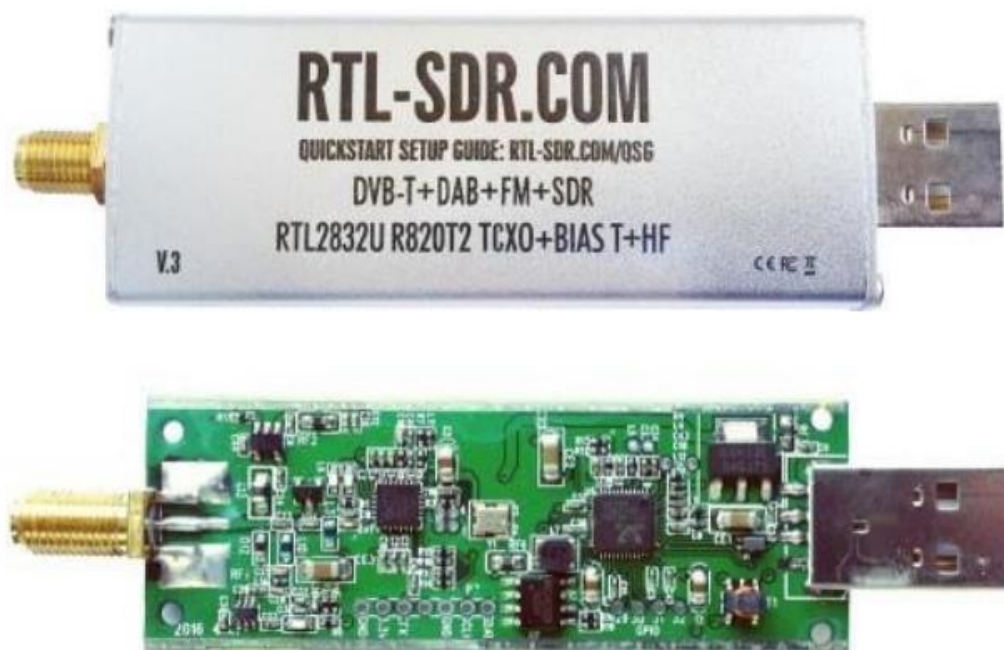
Obrázek 14: Náhled RLT-SDR klíčenky [24]
