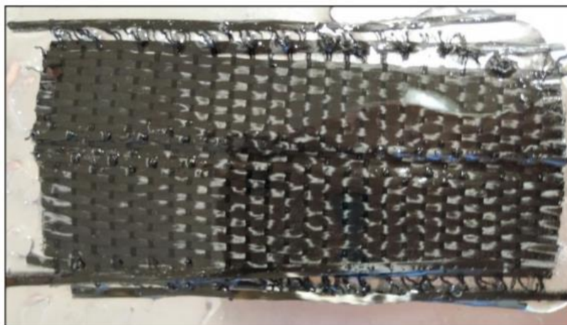
Obr. 10 Smočená uhlíková vlákna tvořící tkaninu [13]
