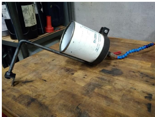
Obr. 18 Nádoba pro přívod procesního média gravitačním způsobem
