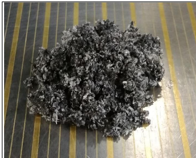
c) Pryskyřice s uhlíkovými vlákny ve formě tkaniny
