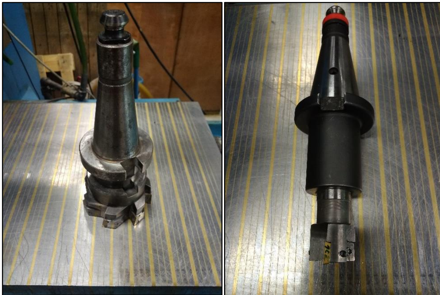
Obr. 16 a) Čelní fréza b) Válcová fréza
