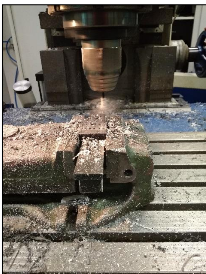
Obr. 25 Vrtání děr pro zavedení termočlánků
