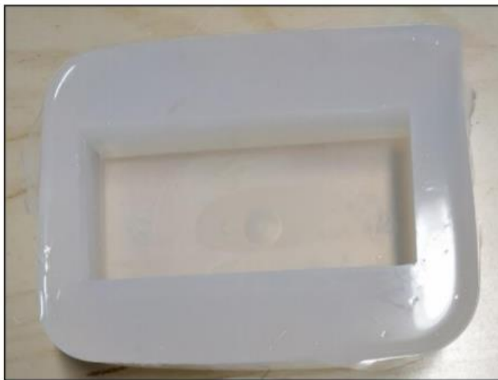
Obr. 08 Silikonová forma na výrobu kompozitních bloků [13]
