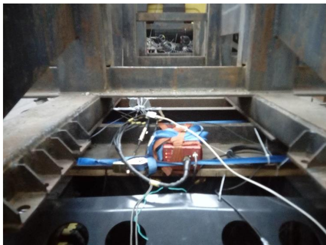
Obr. 29 Inerciální GPS OxTS RT3002 umístěná na rámu vozidla za zadní nápravou
