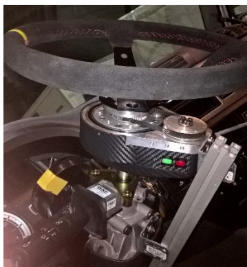
Obr. 30 Měřicí volant nainstalovaný na vozidle
