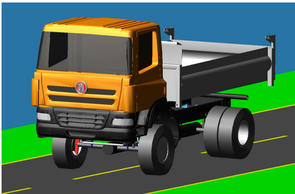
Obr. 15 Kompletní model vozidla Tatra T158 4x4.2 v prostředí MSC ADAMS Car
