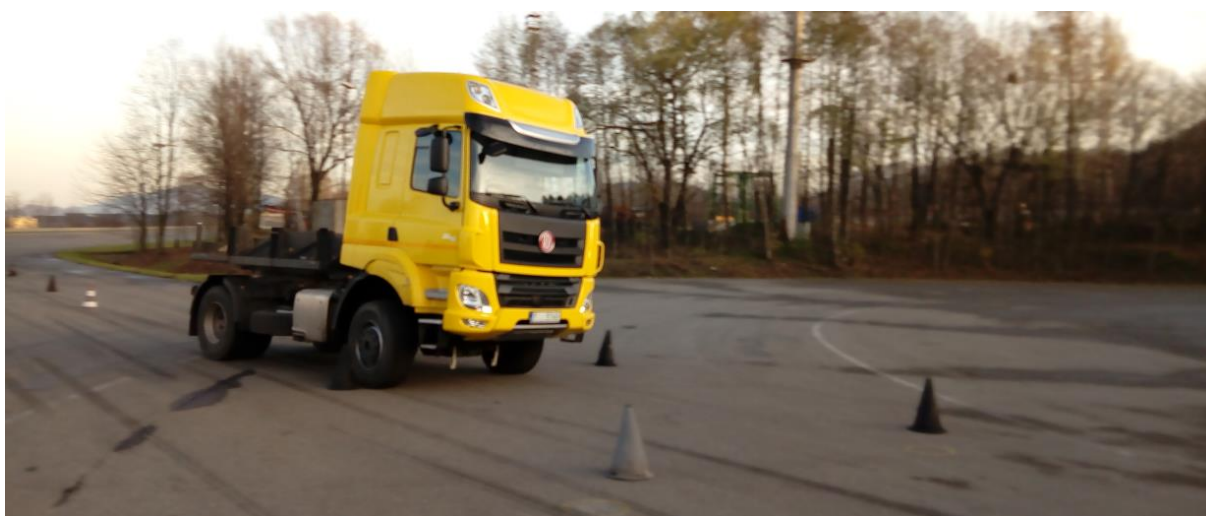
Obr. 26 Vozidlo Tatra 158 Phoenix 4x4 bez nákladu osazené měřicí technikou na testovacím polygonu Tatra v Kopřivnici
