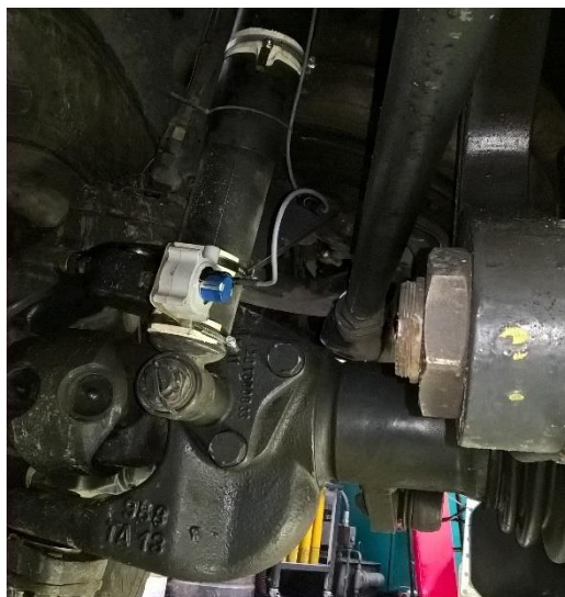
Obr. 31 Lankový potenciometr Celesco SP1-25 nainstalovaný na tlumiči pro měření zdvihu kola
