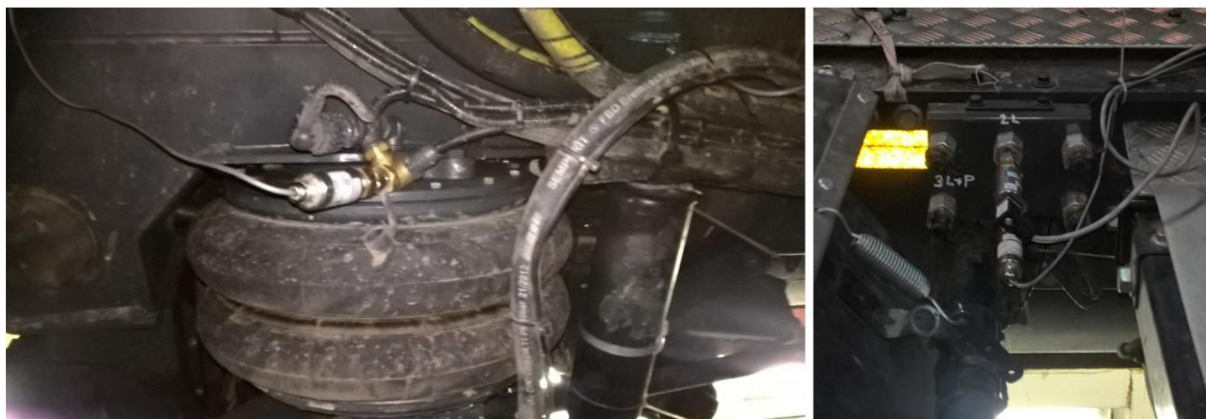
Obr. 33 Snímače tlaku v pneumatických vacích PXM209 na přední nápravě (vlevo) a na měřicích odbočkách zadní nápravy
