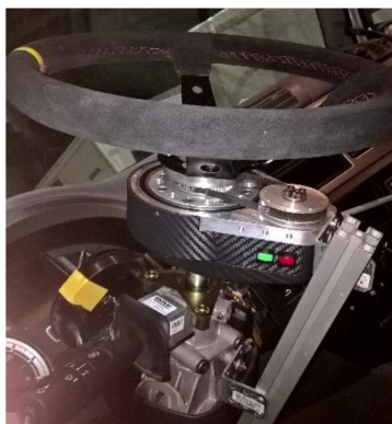
Obr. 30 Měřicí volant nainstalovaný na vozidle
