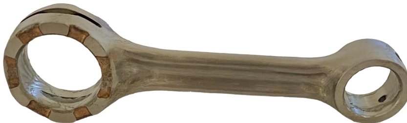
Obr. 34 Upravená ojnice motocyklu YAMAHA YZ 65
