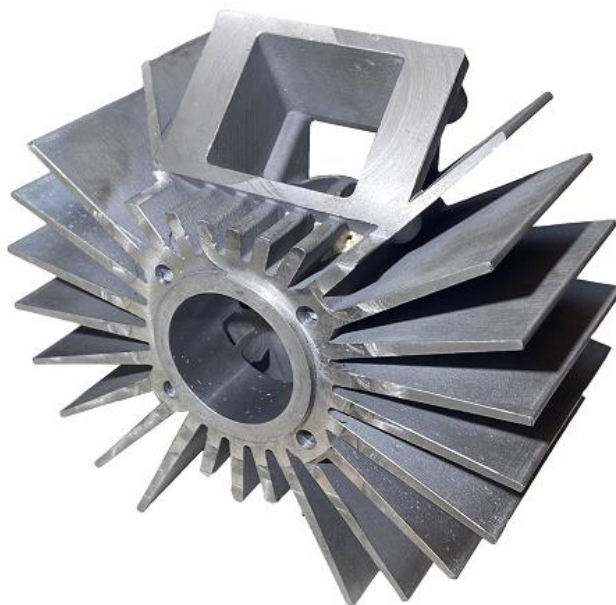
Obr. 37 Odlitek válce motocyklu
