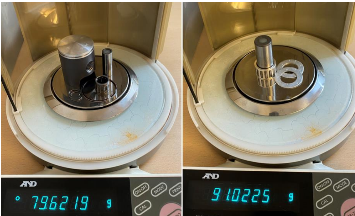
Obr. 43 Vážení komponent klikového mechanismu
