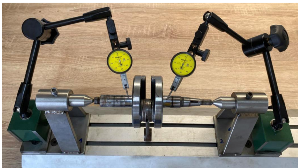
Obr. 83 Centrování skládané klikové hřídele
