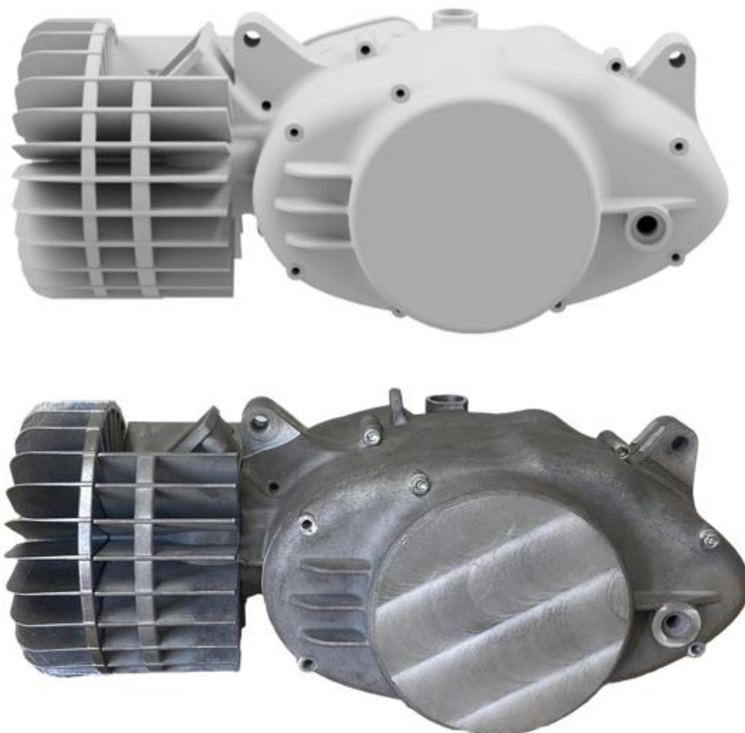
Obr. 87 Porovnání CAD modelu a reálného modelu motoru
