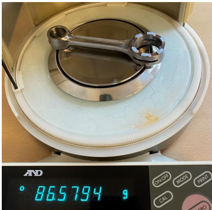
Obr. 40 Vážení ojnice na laboratorních váhách
