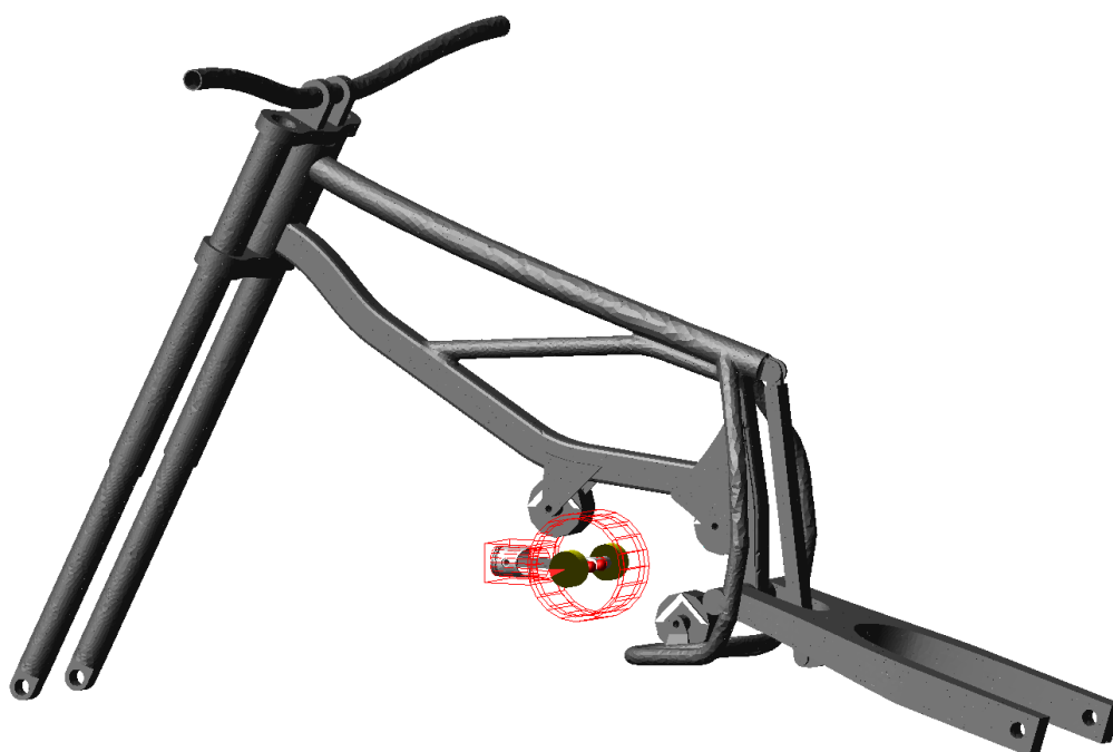
Obr. 69 Umístění rámu a motoru motocyklu v prostředí MSC Adams
