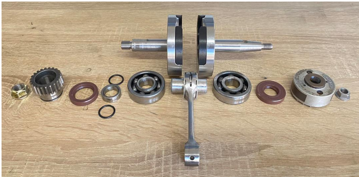
Obr. 82 Reálné komponenty klikového mechanismu
