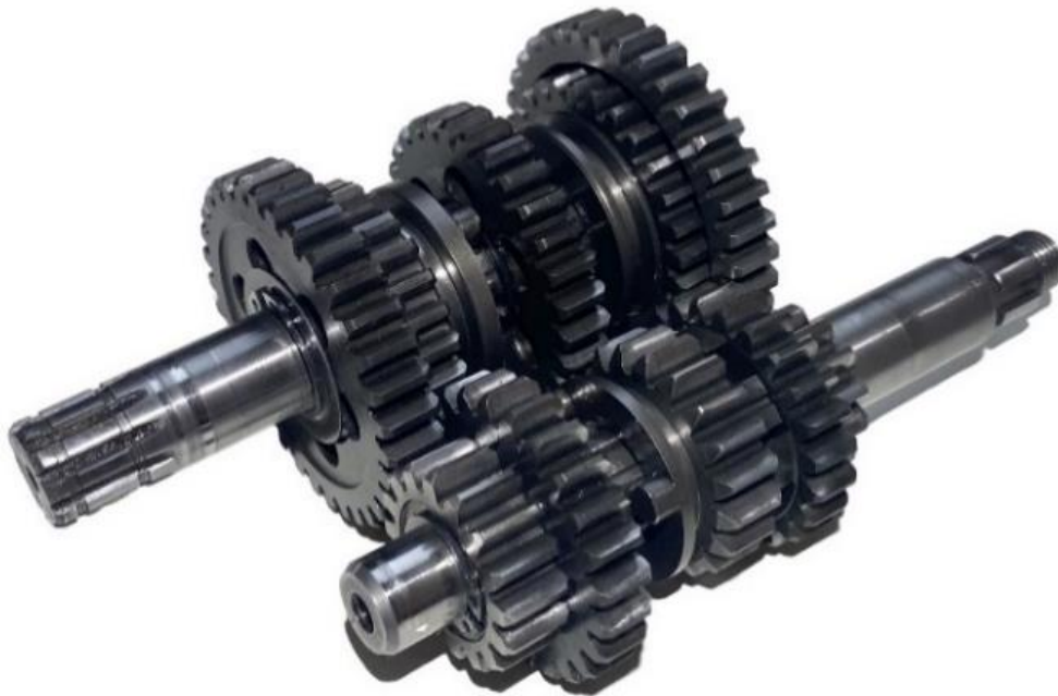
Obr. 36 Převodovka motoru AM3/5
