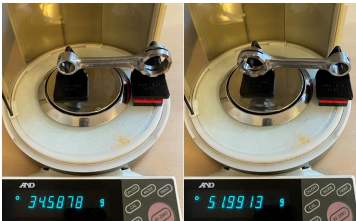
Obr. 41 Vážení malého a velkého oka ojnice
