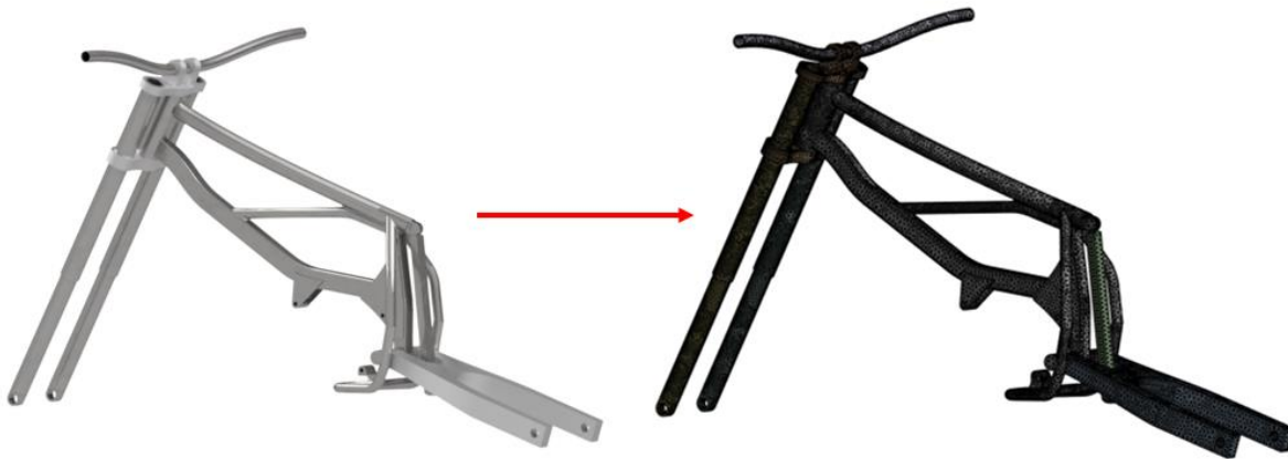
Obr. 67 Převedení CAD modelu rámu na síť konečných prvků
