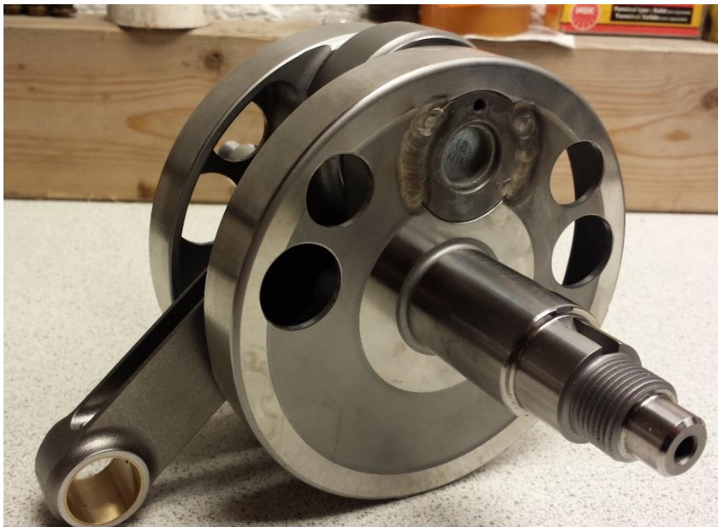
Obr. 9 Lisovaný čep s pomocným svárem [16]
