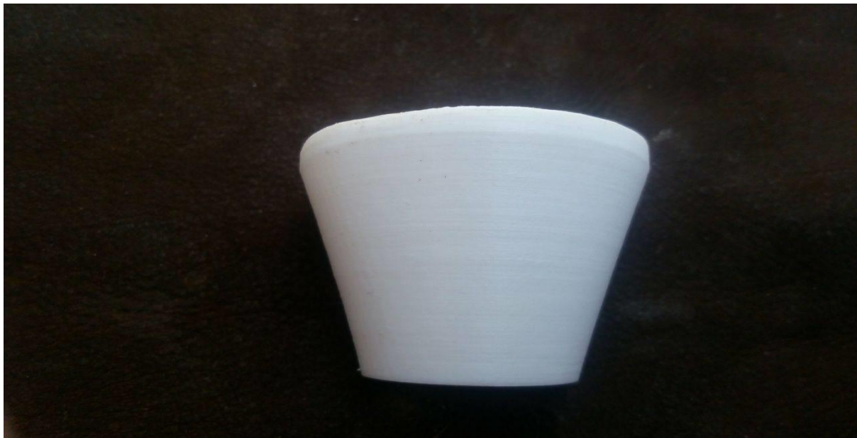
Obr. 36: Původní neopracovaný povrch nástavce.
