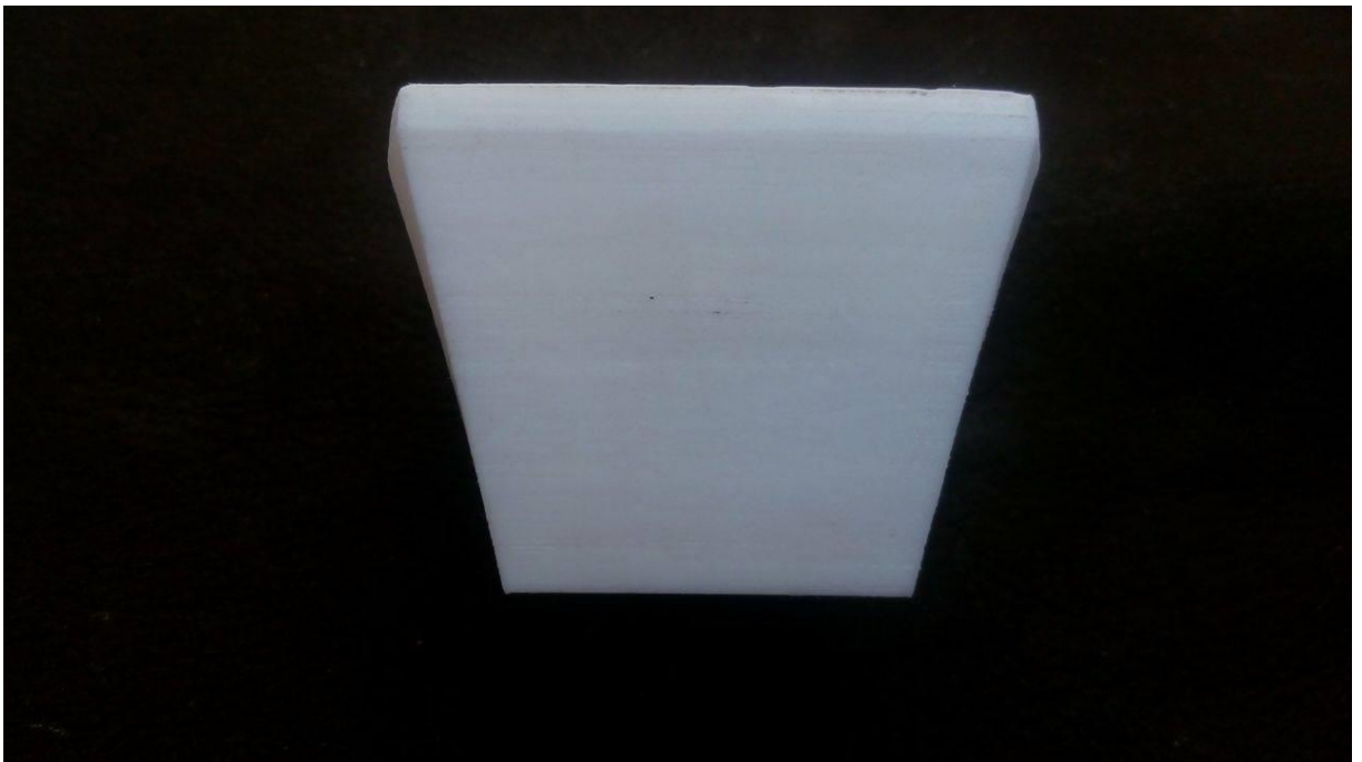
Obr. 35: Plocha vybroušená pilníkem a brusným papírem.
