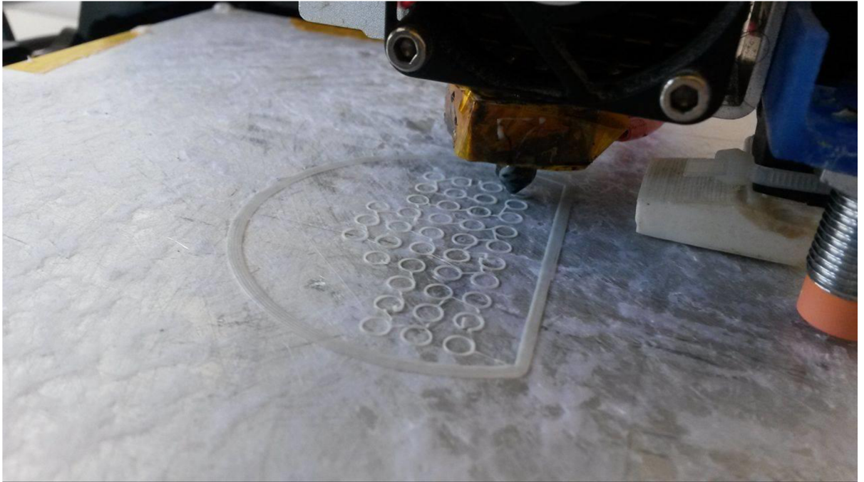
Obr. 31: Nanesení první vrstvy a obrysů Brim.
