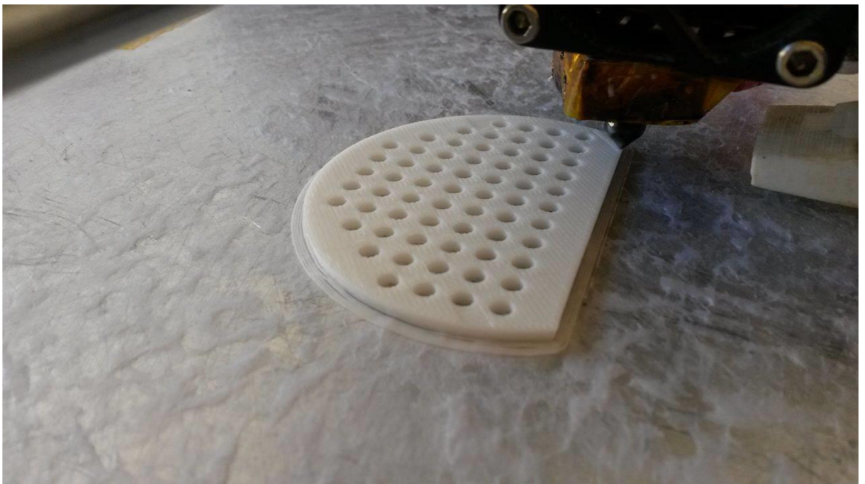
Obr. 32: Proces nanášení jednotlivých vrstev materiálu.
