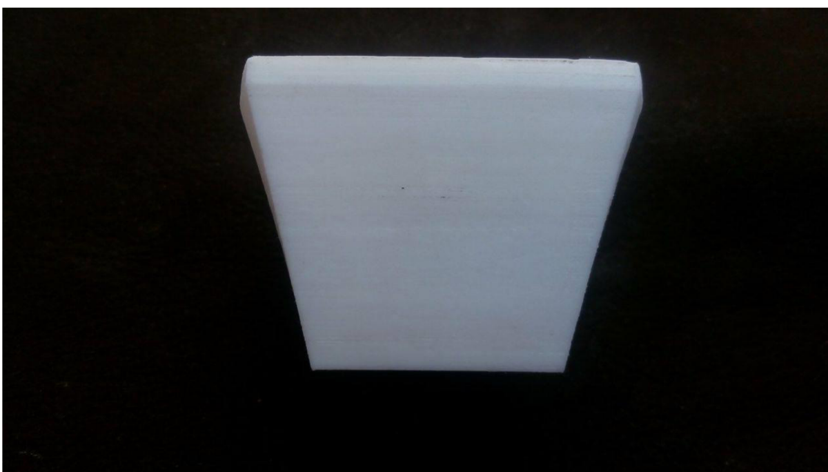
Obr. 35: Plocha vybroušená pilníkem a brusným papírem.
