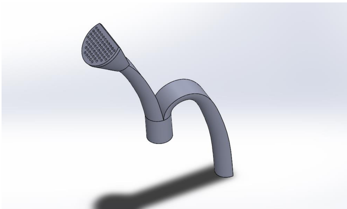
Obr. 26: Hotový model hlavice s nástavcem (7).
