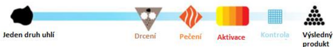
Obr. 2.1 Postup výroby přímo aktivovaného aktivního uhlí [10]
