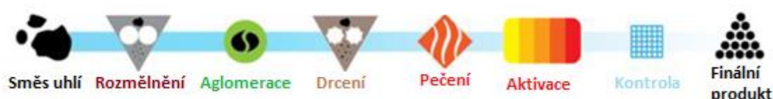
Obr. 2.2 Postup výroby aglomerovaného aktivního uhlí [10]
