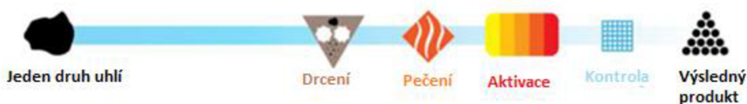
Obr. 2.1 Postup výroby přímo aktivovaného aktivního uhlí [10]
