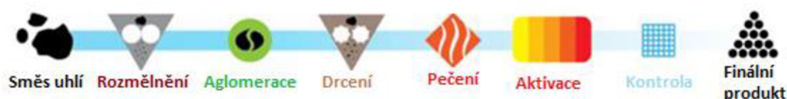
Obr. 2.2 Postup výroby aglomerovaného aktivního uhlí [10]
