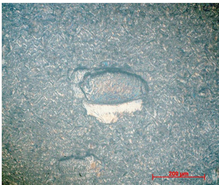
Obr. 37 Mikroskopický snímek materiálu VeroWhitePlus po teplotním zatížení
