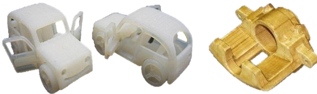
Obr. 15 Výrobky zhotovené technologií LOM [35, 36]
