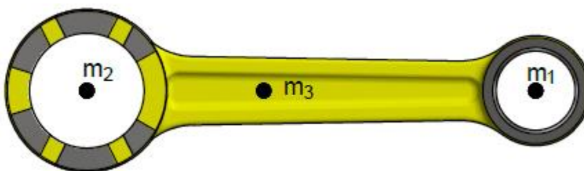
Obr. 3.4 Třibodová redukce hmotnosti ojnice
