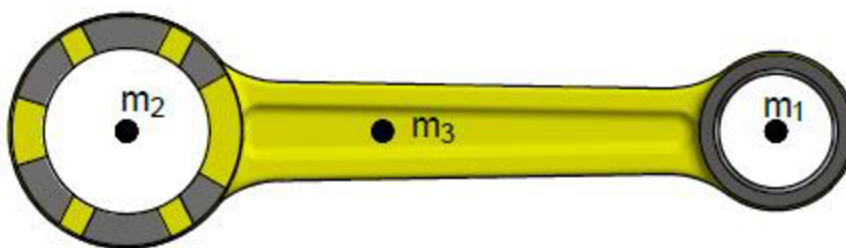
Obr. 3.4 Třibodová redukce hmotnosti ojnice
