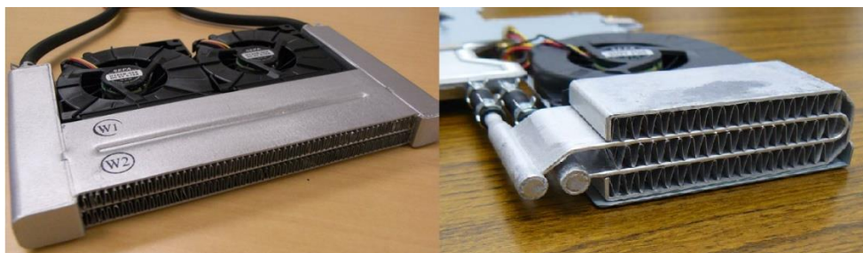
Obrázek 8 Paralelní výměník tepla použitý v notebookech [46; 47]
