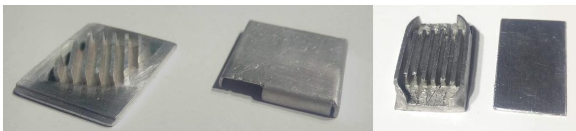
Obrázek 18 Vnitřní uspořádání vodního bloku GPU (vlevo) a vodního bloku CPU (vpravo)
