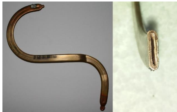
Obrázek 3 Heatpipe (vlevo) a vnitřní drážkovitá struktura (vpravo)
