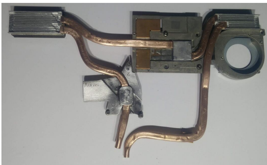
Obrázek 21 Vodní okruh před závěrečným pájením
