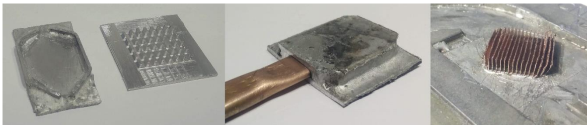
Obrázek 22 Vnitřní struktura vodního bloku CPU (vlevo), vodní blok CPU před pájením měděných trubiček (uprostřed), vnitřní struktura vodního bloku GPU (vpravo)
