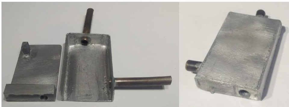
Obrázek 20 Vnitřní struktura expanzní nádoby (vlevo) a výsledná expanzní nádoba (vpravo)
