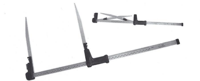
Obrázek 7 - Průměrka mechanická Mantax Black
