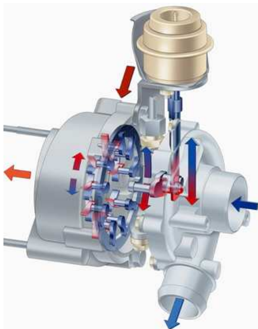
Obr. 16 Princip funkce turbodmychadla s VGT ( resp. VNT) regulací. [3]
