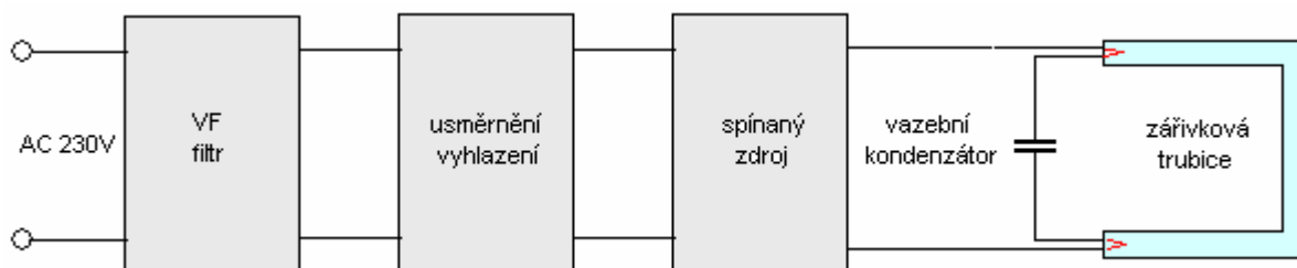
Obr. 3-8 Kondenzátorový startér u kompaktní zářivky
