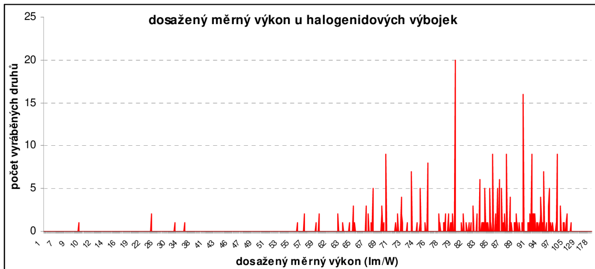
Graf 4-19 Distribuce počtu vyráběných typů halogenidových výbojek dle měrného výkonu
