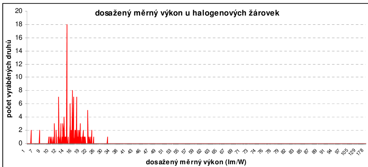
Graf 4-12 Distribuce počtu vyráběných typů halogenových žárovek dle měrného výkonu
