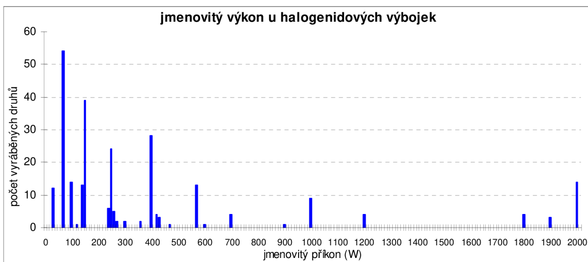
Graf 4-27 Histogram počtu vyráběných typů halogenidových výbojek dle jmenovitého příkonu
