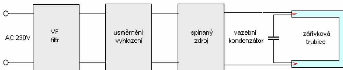
Obr. 3-8 Kondenzátorový startér u kompaktní zářivky
