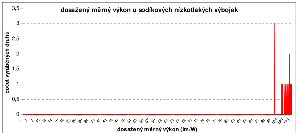
Graf 4-14 Distribuce počtu vyráběných typů sodíkových nízkotl. výbojek dle měrného výkonu
