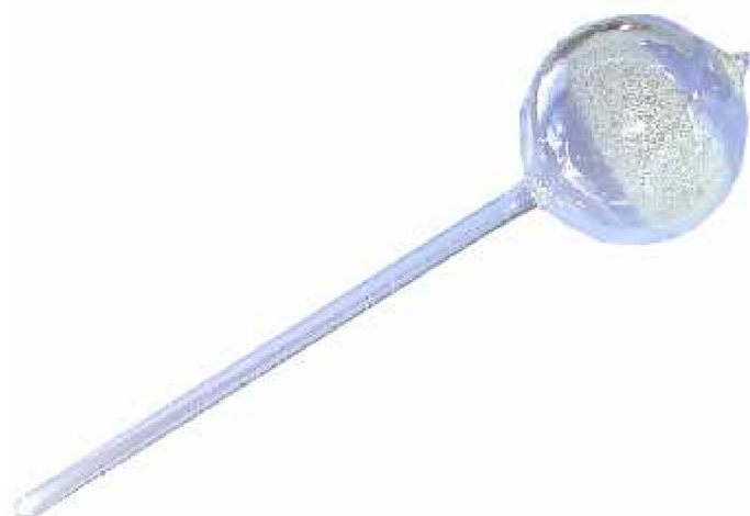
Obr. 3-18 Sirná výbojka Technická univerzita Eindhoven – Philips [21]
