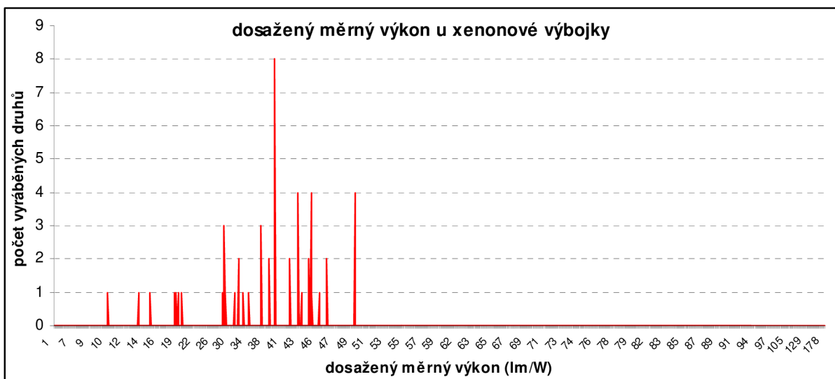
Graf 4-18 Distribuce počtu vyráběných typů xenonových výbojek dle měrného výkonu
