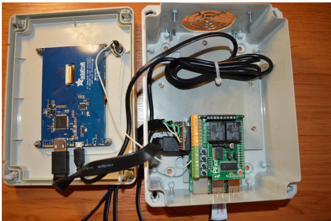
Obrázek 24: Vnitřní provedení řídicí jednotky
