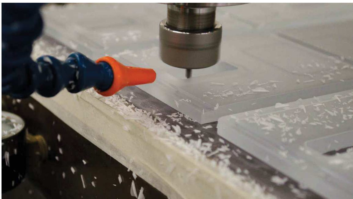
Obr. 7.1 Chlazení plastů pomocí stlačeného vzduchu [48].
