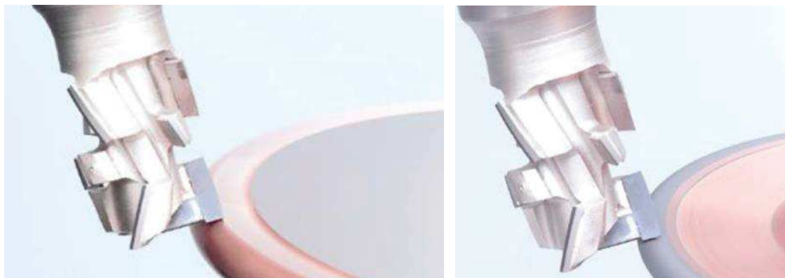
Obr. 4.11 Erodování a broušení hřbetů PCD nástroje [8].
