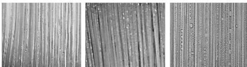
Obrázek 8.11: Vlákna PP výměníku z 20 vrstev v průběhu experimentu s rychlostí 3 m/s a 50 % relativní vlhkost, vertikální poloha (vlevo), 45° (uprostřed), horizontální poloha (vpravo).
