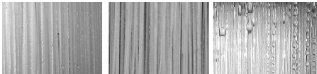
Obrázek 8.8: Vlákna PA výměníku v průběhu experimentu s rychlostí 3 m/s a 50 % relativní vlhkost, vertikální poloha (vlevo), 45^\circ (uprostřed), horizontální poloha (vpravo).
