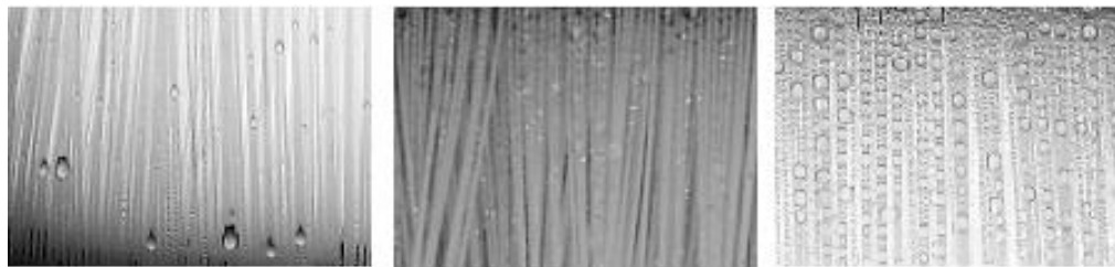
Obrázek 8.9: Vlákna PP výměníku s 6 vrstvami po 8 mm v průběhu experimentu s rychlostí 3 m/s a 50 % relativní vlhkost, vertikální poloha (vlevo), 45° (uprostřed), horizontální poloha (vpravo).
