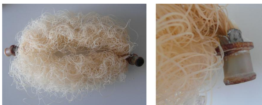
Obrázek 9.4: Zanesený svazek po ukončení testu.
