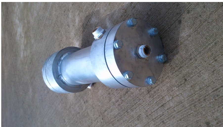
Obrázek 7.1: Prototyp HE6 pro měření v režimu voda-pára.
