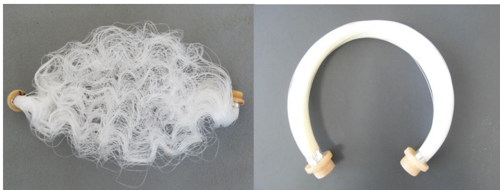
Obrázek 9.1: Svazek skládající se z kadeřených vláken (vlevo), svazek složený z rovných vláken (vpravo).
