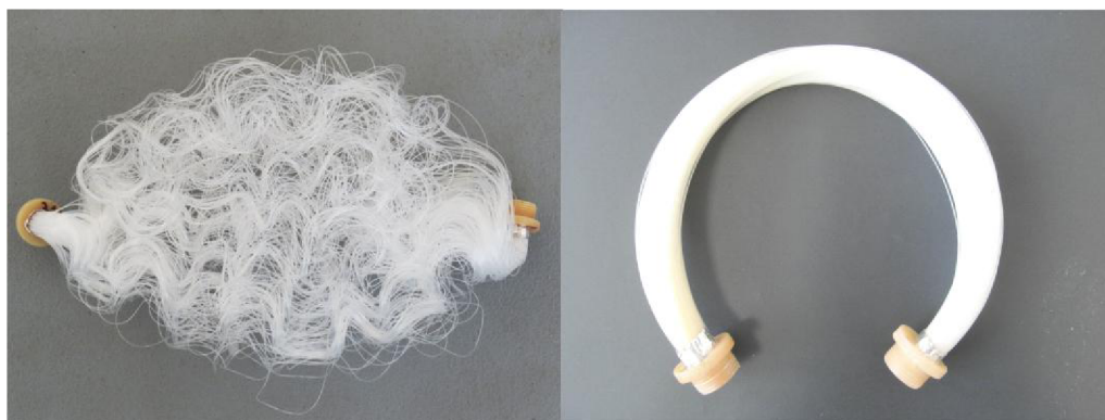
Obrázek 9.1: Svazek skládající se z kadeřených vláken (vlevo), svazek složený z rovňých vláken (vpravo).
