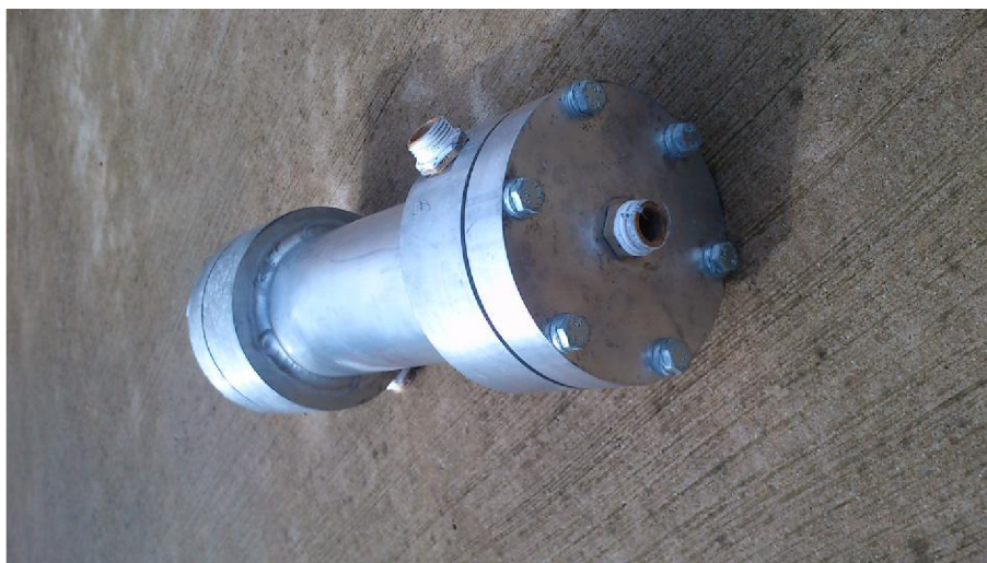
Obrázek 7.1: Prototyp HE6 pro měření v režimu voda-pára.
