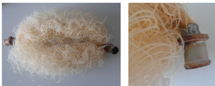
Obrázek 9.4: Zanesený svazek po ukončení testu.
