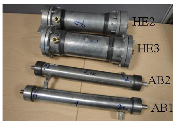
Obrázek 5.1: Prototypy polymerních výměníků tepla z dutých vláken.
