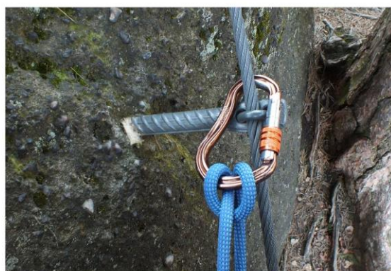
f) Konečná fáze uzlu po jeho přechodu přes karabinu
