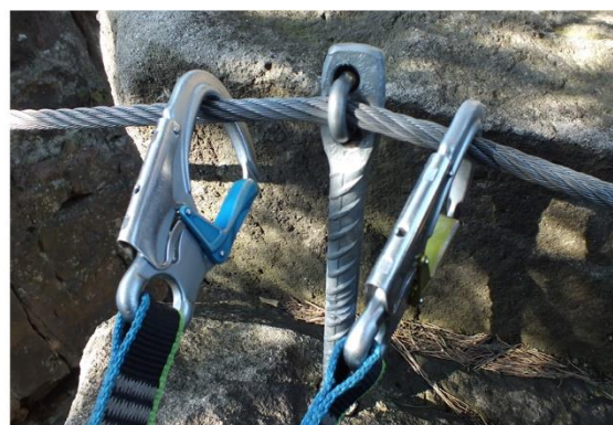
b) Přejchod přes kotvení
