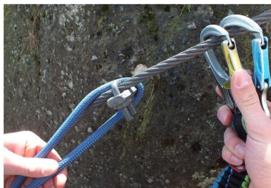
b) Přehození lana přes kotvení
