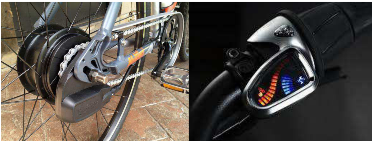
Obr.14 NuVinci Harmony systém namontovaný na bicykli a jeho ovládanie
