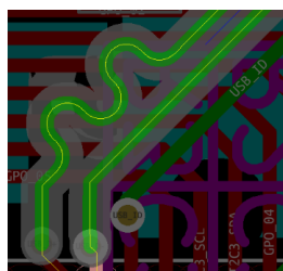
Obr. 20 Příklad úpravy spojů tvořících diferenciální pár
