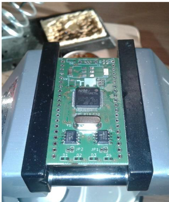
Obr. 24 Osazování desky součástkami
