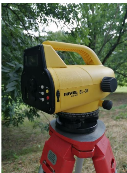
Obrázek 3.4 - Nivelační přístroj Nivel System EL-32 (vlastní)
