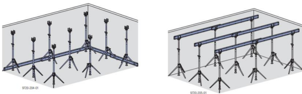
Obr. 9.4. Montáž bednění Dokaflex 1-2-4 zdroj: www.doka.com/cz
