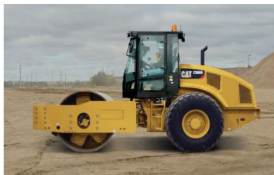
Obr. 6.5. Vibrační válec CAT CS68B Zdroj: https://zeppelin.cz/online-katalog
