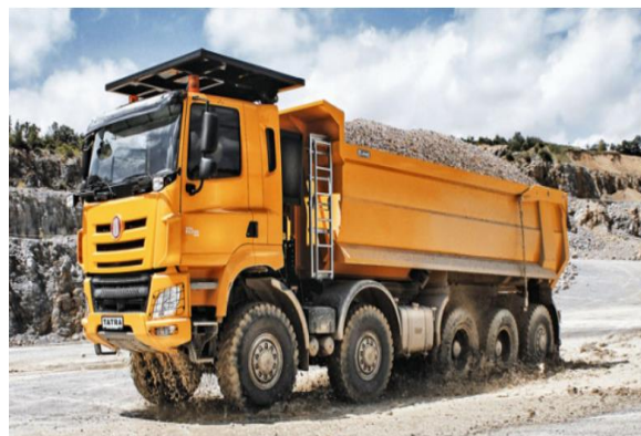
Obr. 6.3. Sklápěč Tatra T158 Phoenix 6x6 Zdroj: https://www.automobilrevue.cz
