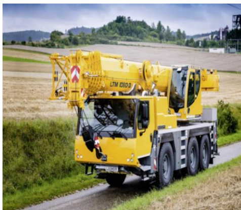
Obr. 6.18. Autojeřáb Liebherr LTM 1060-3.1 Zdroj: https://www.liebherr.com
