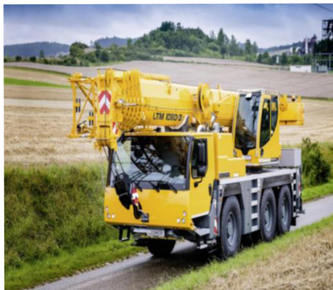
Obr. 6.18. Autojeřáb Liebherr LTM 1060-3.1 Zdroj: https://www.liebherr.com
