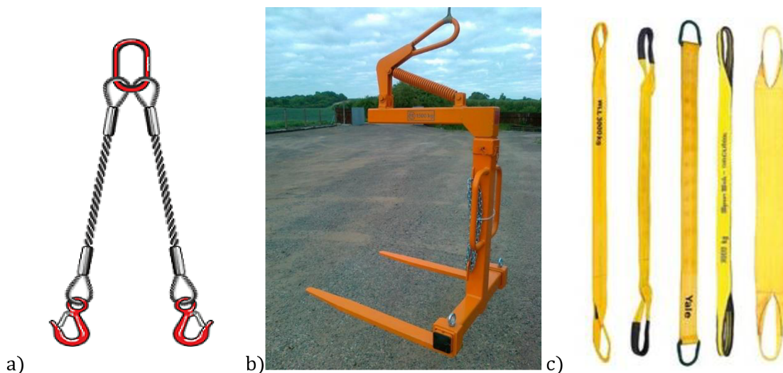
Obr. 6.26. Vázací prostředky a) dvoupramenný řetěz; b) závěsné vidle na palety; c) vázací pásy
