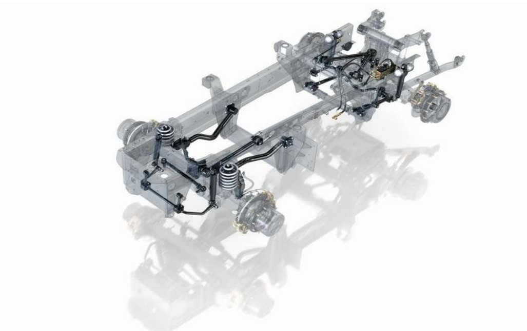
Obrázek č. 14 Odpružení přední a zadní nápravy systémového nosiče Fastrac
