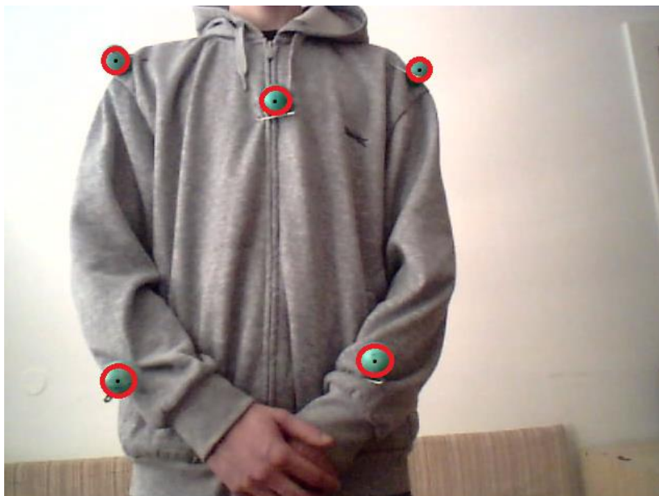
Obrázok 7-7 Pozície značiek nájdené pomocou metódy HoughCircles() .
