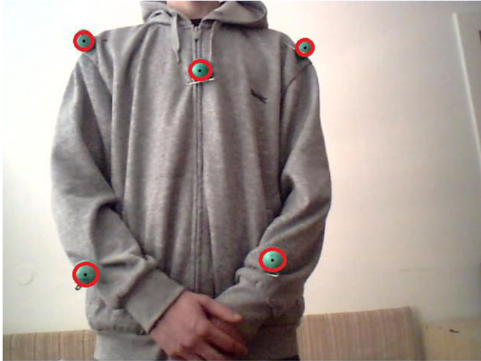
Obrázok 7-7 Pozície značiek nájdené pomocou metódy HoughCircles() .
