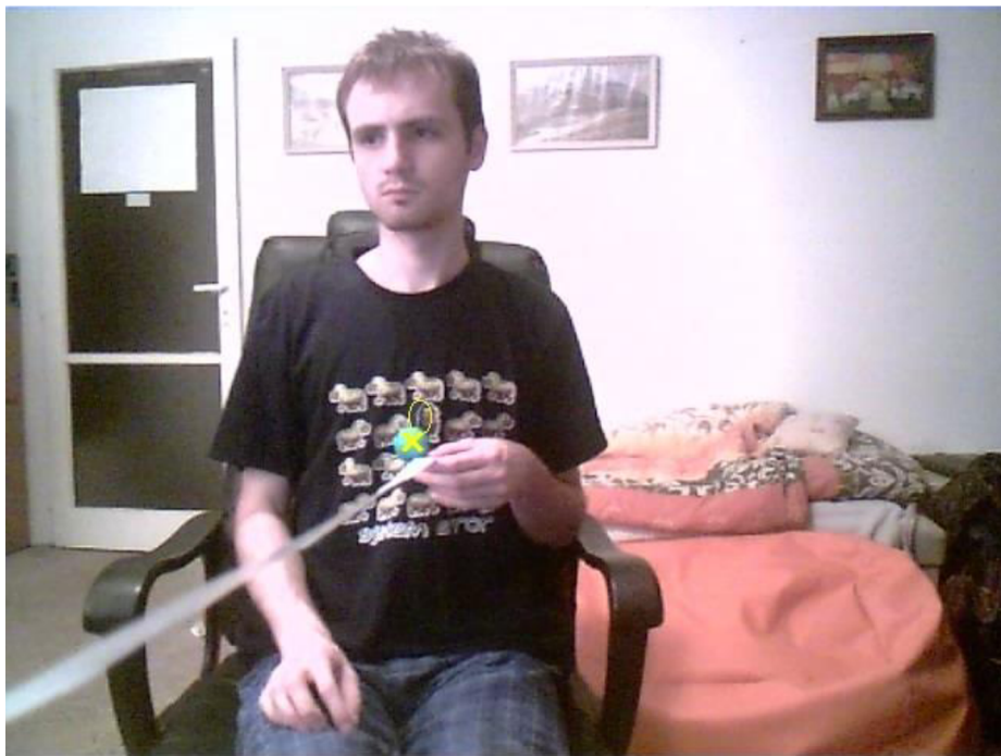
Obrázok 8-1 Testovanie triangulácie metrovou vzdialenosťou od kamery.
