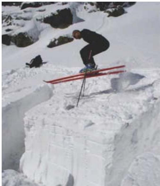
Obr. č. 4: Provádění testu Klouzavý blok (zdroj: Lienherth & Nádvorník, 2004)
