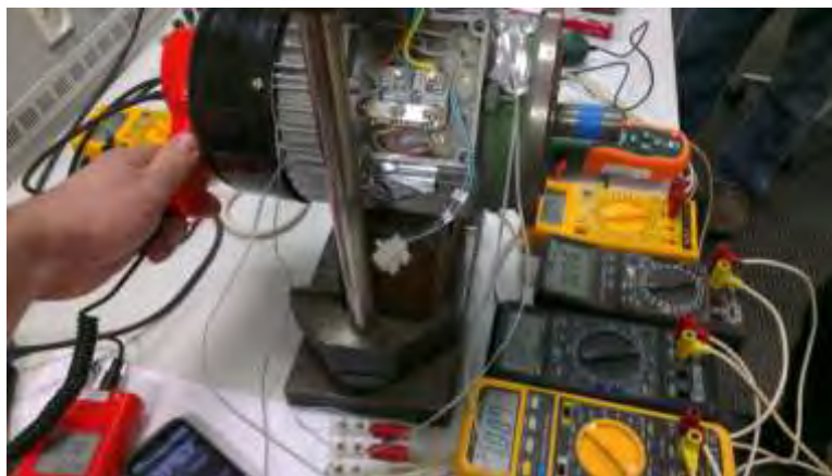
Obr. 5.2.1: Měřící pracoviště – motor Lenze
