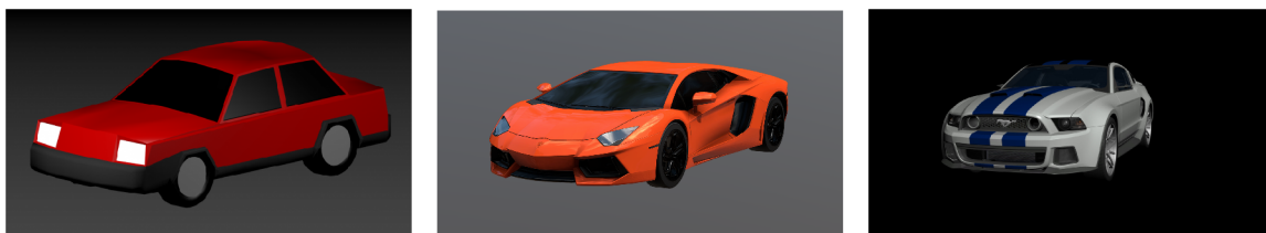
Obrázek 9.1: Náhled modelů použitých v experimentu. Model o velikosti 108kB s počtem trojúhelníků 1 172 (vlevo), model o velikosti 5.8MB s počtem trojúhelníků 34 126 (vprostřed) a model o velikosti 14.1.MB s počtem trojúhelníků 125 407 (vpravo).
