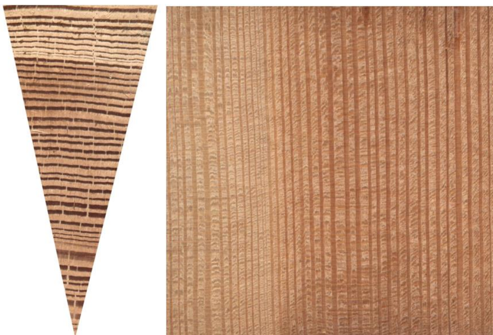
Obrázek 19 - příčný a radiální řez modřín (Ústav nauky o dřevě a dřevařských technologiích , 2022)
