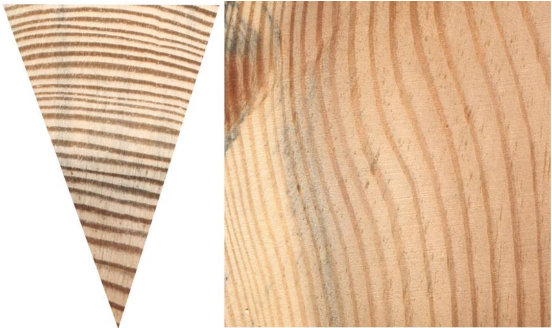
Obrázek 18 - příčný a radiální řez borovice (Ústav nauky o dřevě a dřevařských technologií , 2022)
