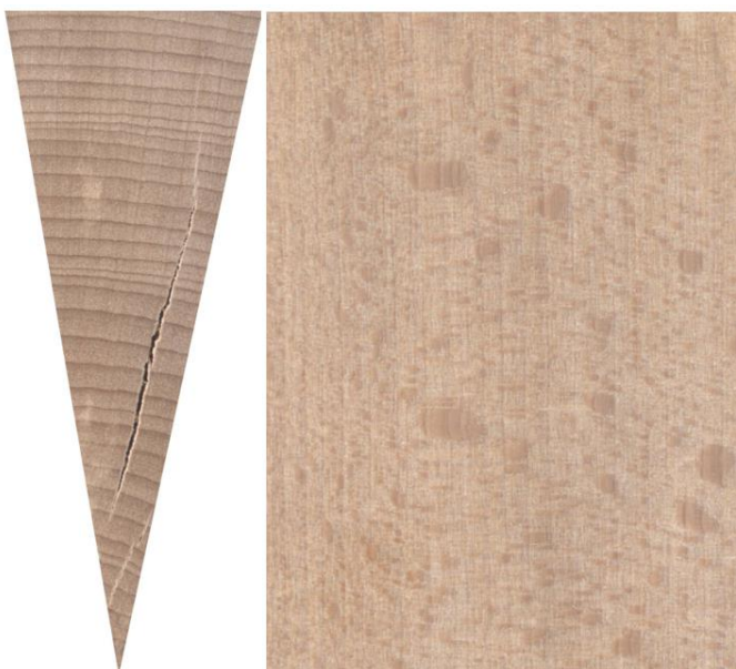
Obrázek 15 - Příčný a radiální řez bukem (Ústav nauky o dřevě a dřevařských technologiích, 2022)
