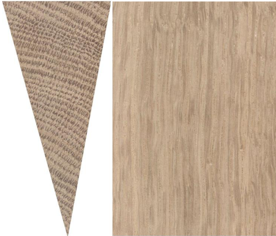
Obrázek 14 - Příčný a radiální řez dubem (Ústav nauky o dřevě a dřevařských technologiích, 2022)
