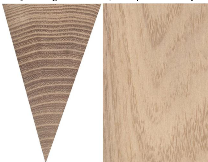
Obrázek 13 - Příčný a tangenciální řez akátem (Ústav nauky o dřevě a dřevařských technologií, 2022)
