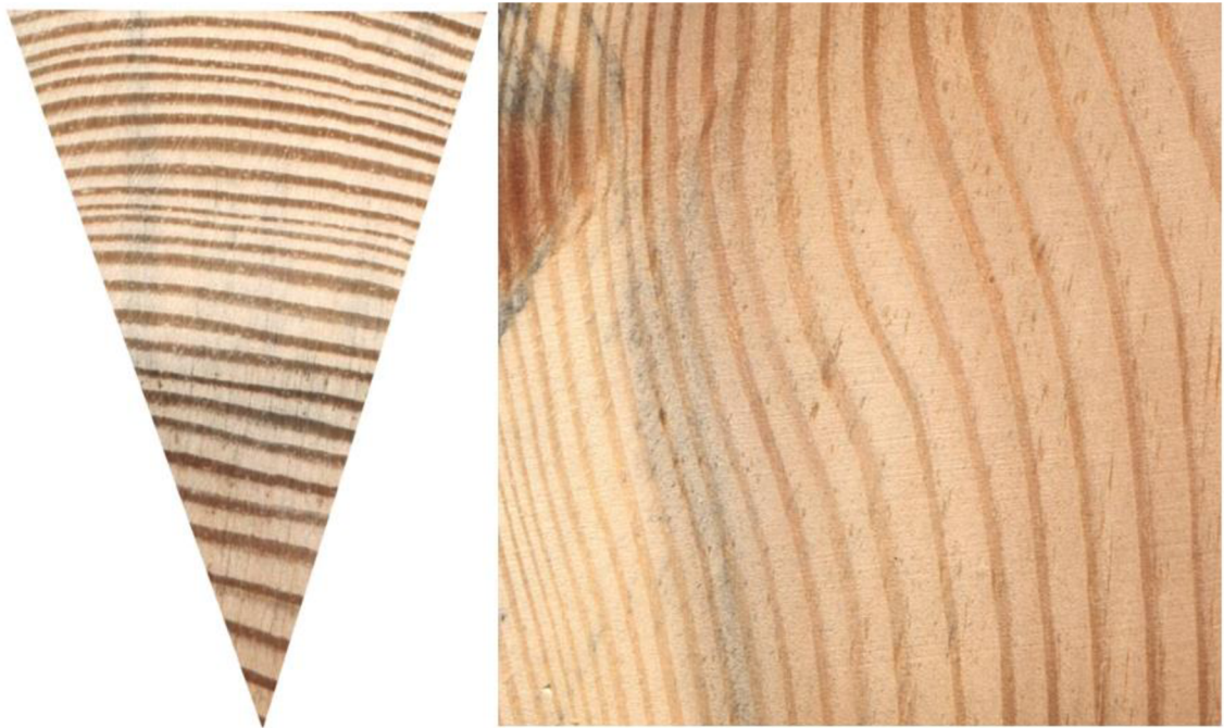
Obrázek 18 - příčný a radiální řez borovice (Ústav nauky o dřevě a dřevařských technologiích, 2022)
